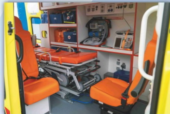
Салон нового реанимобиля, оснащенный медицинской мебелью и самым современным оборудованием: дефибрилляторами, аппаратами искусственной вентиляции легких. 29 июня 2020 г.
